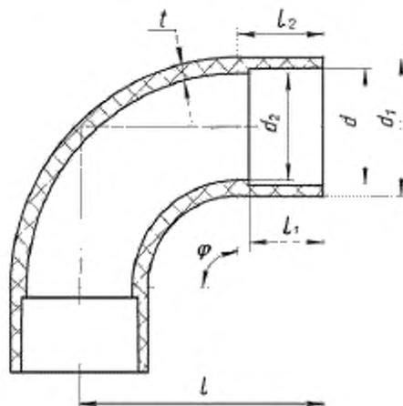
*l – уложенная длина отвода; l1 – глубина соединения; l2 – длина концевой части;
