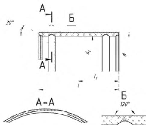
$d$  – наружный диаметр муфты;  $d_1$  – внутренний диаметр муфты;  $l$  – длина муфты;  $l_1$  – глубина соединения
