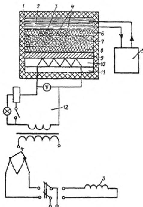
1 - теплоизоляционная камера; 2 - холодильник; 3 - тепломер; 4 - термопара; 5 - термостат; 6 и 8 – слои резины; 7 - образец; 9 - дюралюминий; 10 - нагреватель; 11 - асбест; 12 - регулируемый электроннагреватель
