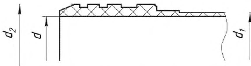
$d$  – внутренний диаметр трубы;  $d_1$  – наружный диаметр трубы;  $d_2$  – диаметр nipples
