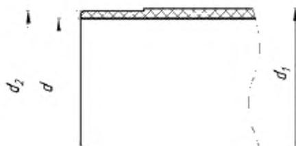
$d$  – внутренний диаметр трубы;  $d_1$  – наружный диаметр трубы;  $d_2$  – диаметр nipples
