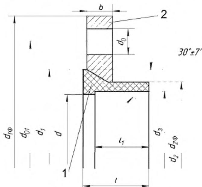
1 – бурт; 2 – накидное кольцо;  $l$  – длина бурта;  $l_1$  – длина соединения;  $d$  – диаметр проходной;  $d_1$  – максимальный диаметр бурта;  $d_2$  – наружный диаметр бурта;  $d_3$  – внутренний диаметр бурта;  $d_{2\phi}$  – внутренний диаметр накидного кольца;  $d_{01}$  – диаметр по центру присоединительных отверстий;  $d_{1\phi}$  – наружный диаметр накидного кольца;  $d_0$  – диаметр присоединительных отверстий,  $b$  – ширина накидного кольца.
