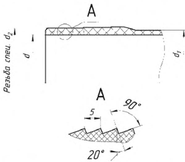
$d$  – внутренний диаметр трубы;  $d_1$  – наружный диаметр трубы;  $d_2$  – диаметр nipples
