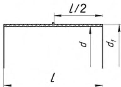
$l$  – длина втулки;  $d_1$  – наружный диаметр;  $d$  – внутренний диаметр
