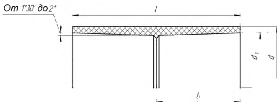
$d$  – наружный диаметр муфты;  $d_1$  – внутренний диаметр муфты;  $l$  – длина муфты;  $l_1$  – глубина соединения
