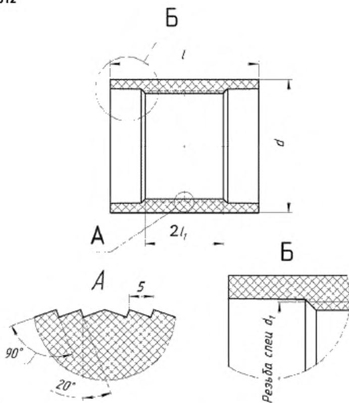
$d$  – наружный диаметр муфты;  $l$  – длина муфты;  $l_1$  – глубина соединения
