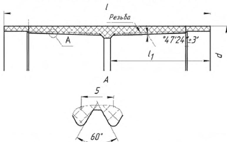
$d$  – наружный диаметр муфты;  $l$  – длина муфты;  $l_1$  – глубина соединения
