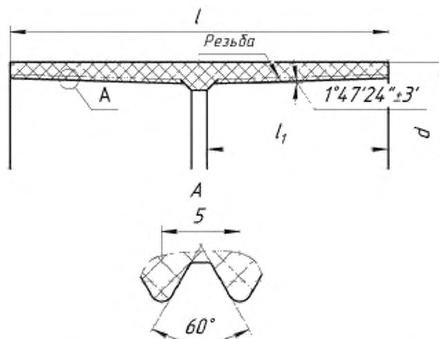
$d$  – наружный диаметр муфты;  $l$  – длина муфты;  $l_1$  – глубина соединения
