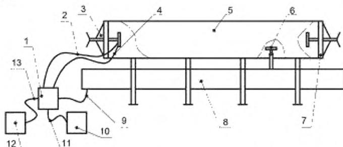
1 – гидروпульт; 2 – рукав высокого давления; 3 – опора неподвижная с узлом зажима; 4 – рукав низкого давления; 5 – бронекamera; 6 – люнет опорный; 7 – опора подвижная с узлом зажима; 8 – бак; 9 – рукав циркуляционный; 10 – насос низкого давления; 11 – рукав низкого давления; 12 – насос высокого давления; 13 – рукав высокого давления
