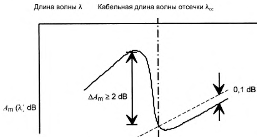
Рисунок 6 – Измерение длины волны отсечки при использовании методики эталонного многомодового волокна
