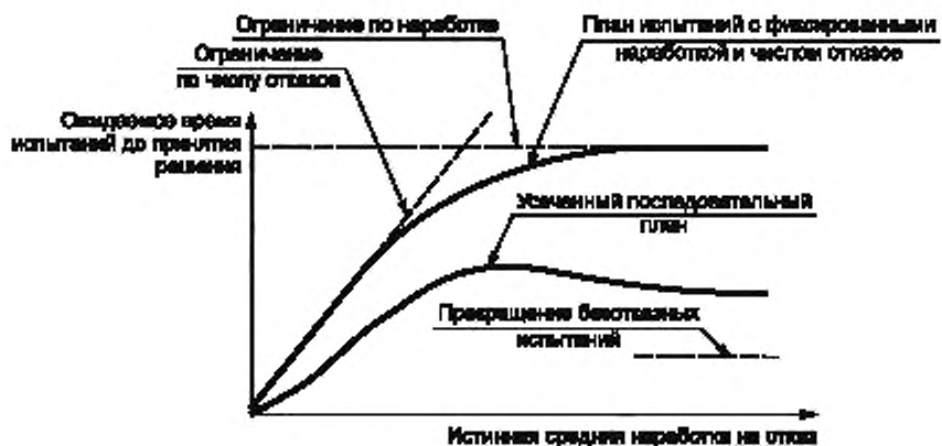
Рисунок 2 — Ожидаемая суммарная продолжительность испытаний до принятия решения в зависимости от истинной средней наработки изделий на отказ
