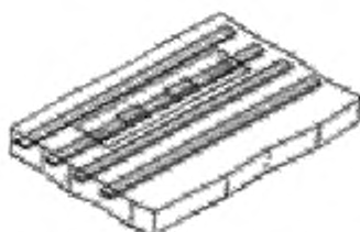
Рисунок 24 г — Припаивание сменного проводника
