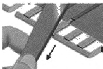
Рисунок 34 d — Снятие надфилем выступающей части нового контактного элемента
