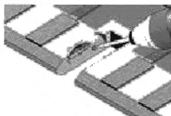
Рисунок 14 а — Удаление поврежденного материала фрезерованием
