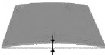
Рисунок 12 а — Проверка прогиба печатной платы
