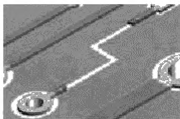
Рисунок 19 а — Удаление покрытия с концов оставшихся проводников
