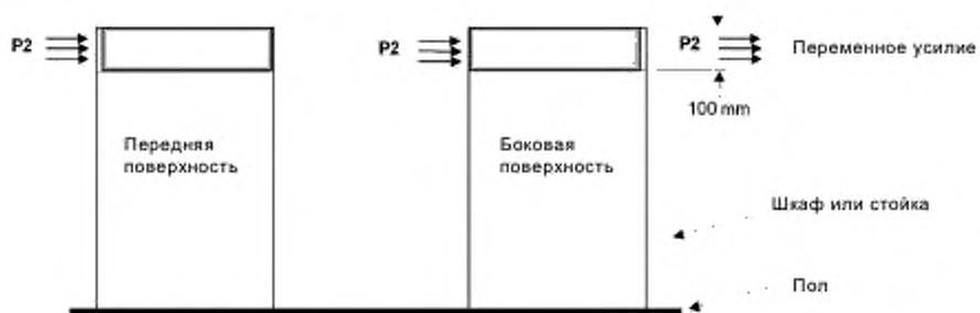
Рисунок 2 - Испытание шкафов и стоек на жесткость
