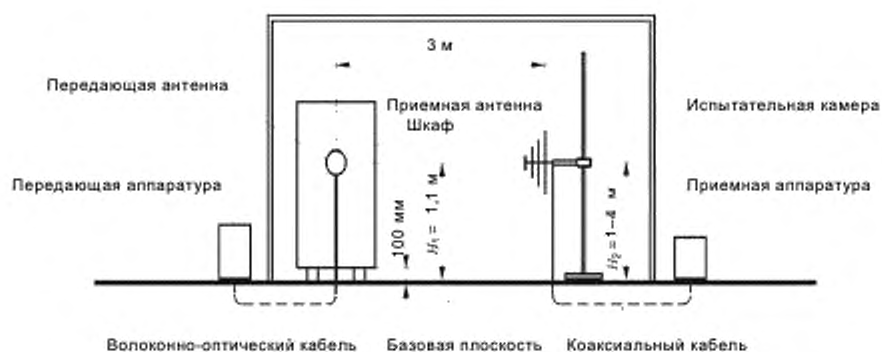
Рисунок 7 – Установка для измерения рассеяния силы сигнала поля E_2 (шкаф)
