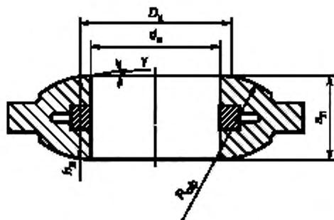
Рисунок 22 — Компенсирующая линза
