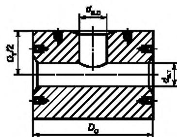
Рисунок 14 — Тройник (тип Д)
