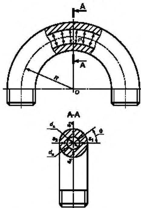
Рисунок 6 — Криволинейный элемент трубопровода
