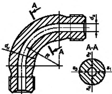
Рисунок 2 — Колено трубопровода
