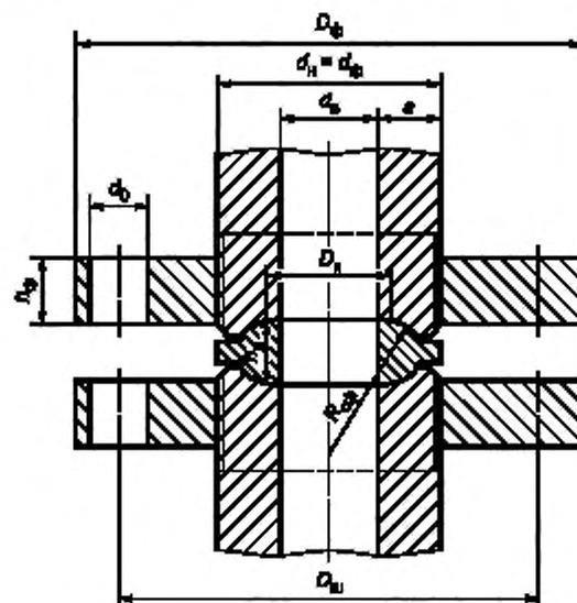
Рисунок 18 — Фланцевое соединение
