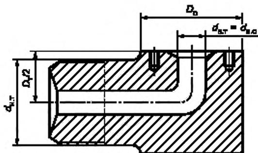
Рисунок 16 — Угольник (тип А)
