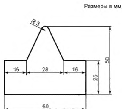
Рисунок 2 — Поперечный профиль и размеры бойка
