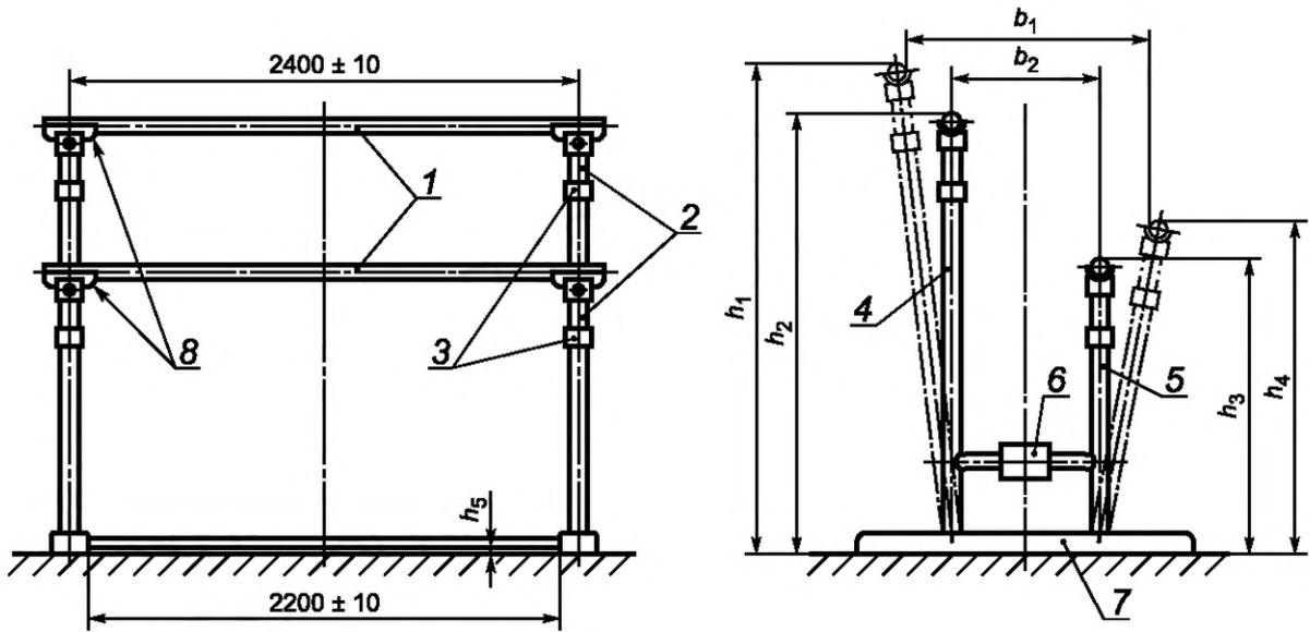
1 — жердь; 2 — выдвижная стойка; 3 — замок с регулировочным устройством; 4 — высокая опора брусьев; 5 — низкая опора брусьев; 6 — горизонтальное регулировочное устройство; 7 — пол; 8 — вертлюг
