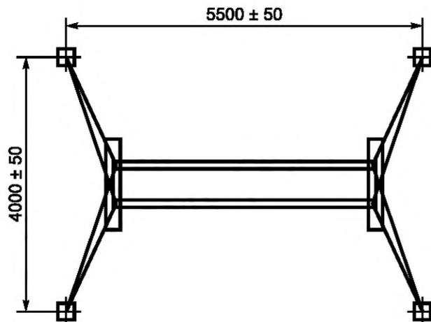
Рисунок 2 — Пример анкерного крепления асимметричных брусьев типа 2
