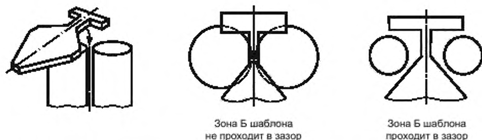
Рисунок Г.8 — Испытания прямоугольных зазоров с использованием зоны Б шаблона
