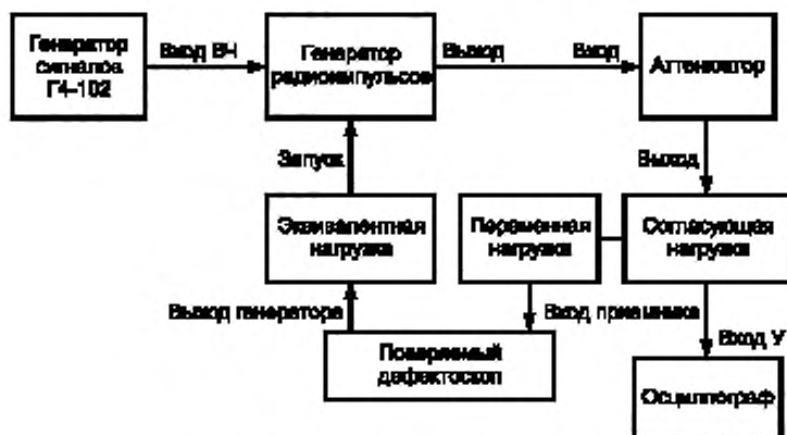
Рисунок 1 — Схема установки для поверки дефектоскопов
