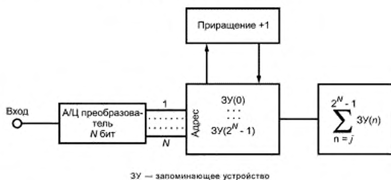
Рисунок G.2 — Блок-схема устройства измерения функции распределения амплитуд ИРП с аналого-цифровым преобразователем
