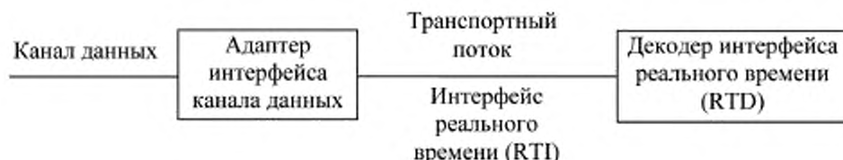
Рисунок 1 — Схема интерфейса реального времени (RTI)
