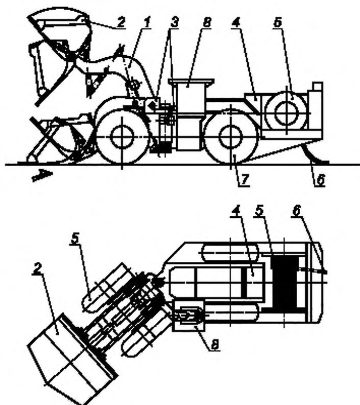
1 — манипуляционное устройство; 2 — ковш; 3 — шарнирно сочлененная рама; 4 — электрический привод;
