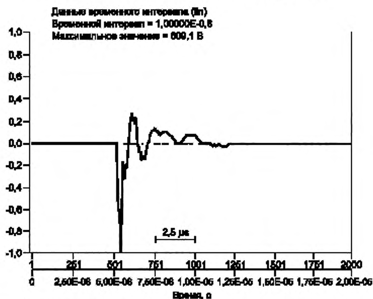
Рисунок 15 — Пример высокочастотного импульса коммутационного перенапряжения
