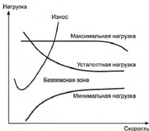
Рисунок 5 — Примеры критериев выбора подшипника
