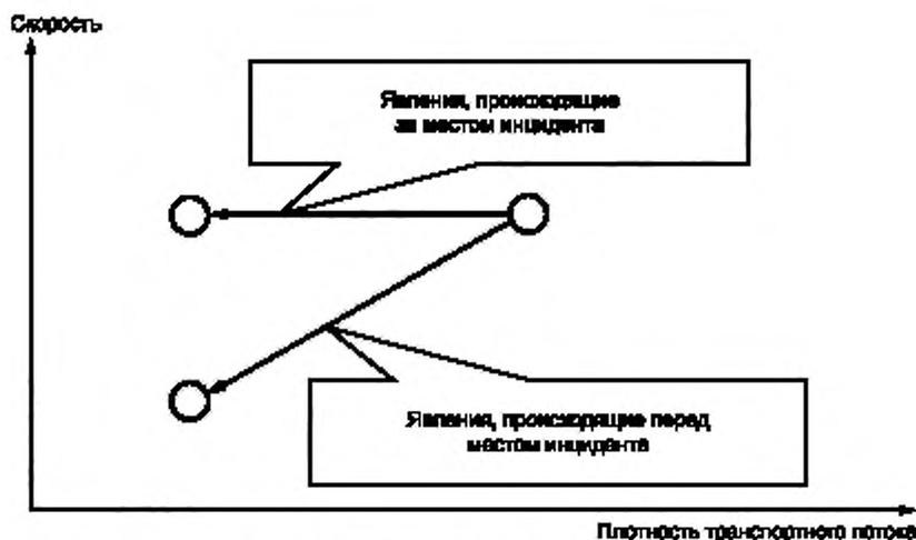
Рисунок 1.2 — Модель явлений, происходящих при транспортном заторе
