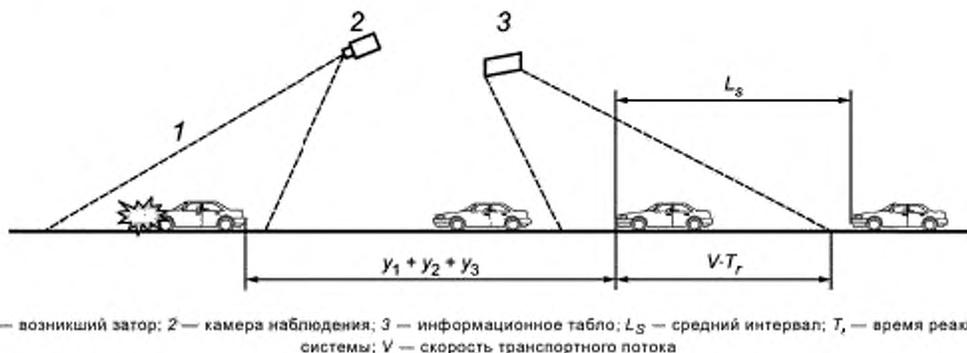
Рисунок 5 — Схема, отображающая время реакции системы в терминах расстояний
