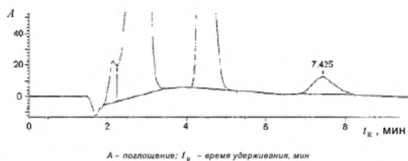
Рисунок В.4 – Хроматограмма, полученная на УФ детекторе при длине волны \lambda = 242 нм для МР-производного 2,4-ТДИ
