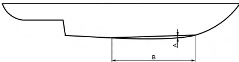
A — отклонение от прямой (показано положительное); B — длина хода
