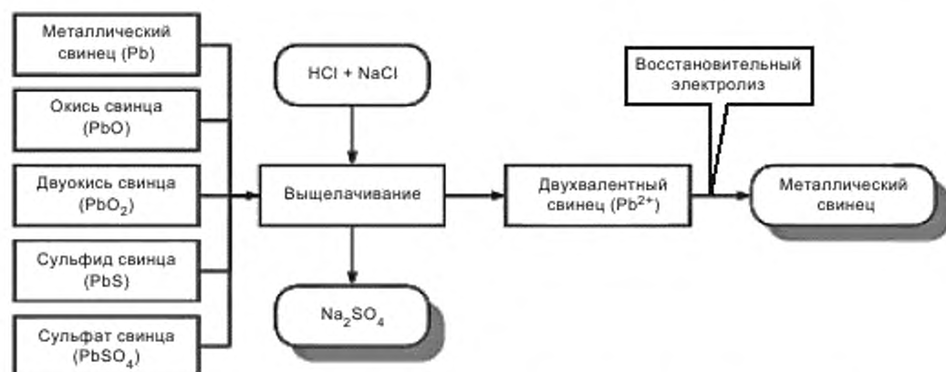
Рисунок 4 — Электрохимические процессы при гидрометаллургическом производстве свинца
