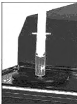
Рисунок 1 — Шприц, установленный в входное отверстие
