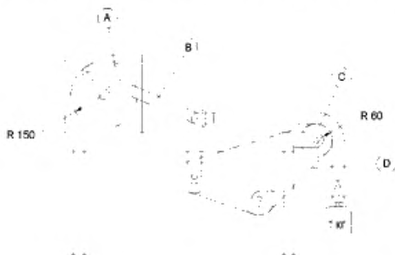
A — кривошипный механизм; B — соединительная тяга; C — ролик диаметром 120 мм; D — ремень с абразивной лентой
