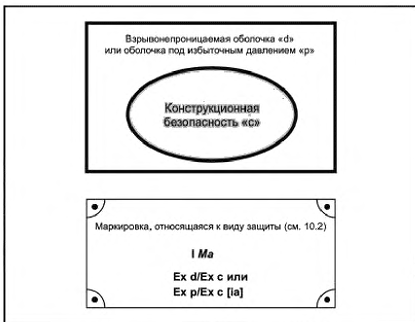
Рисунок 5 — Оборудование уровня взрывозащиты Ma (конструкционная безопасность «с» внутри взрывонепроницаемой оболочки «d» или оболочки под избыточным давлением «р»)
