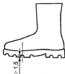
Рисунок В.1 — Трещины на подошве
