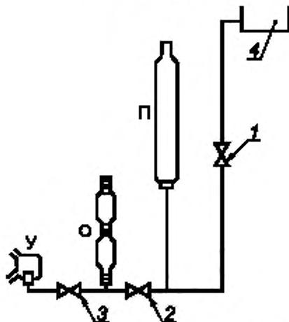
П — поверяемая пипетка; О — образцовая пипетка; У — уравнительная трубка. 1—3 — краны; 4 — резервуар для воды
