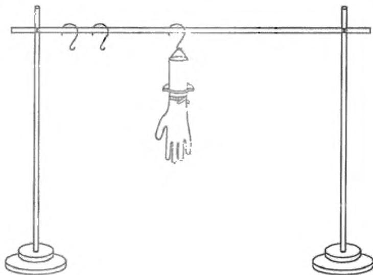
Рисунок А.2 – Приспособление для удержания перчатки
