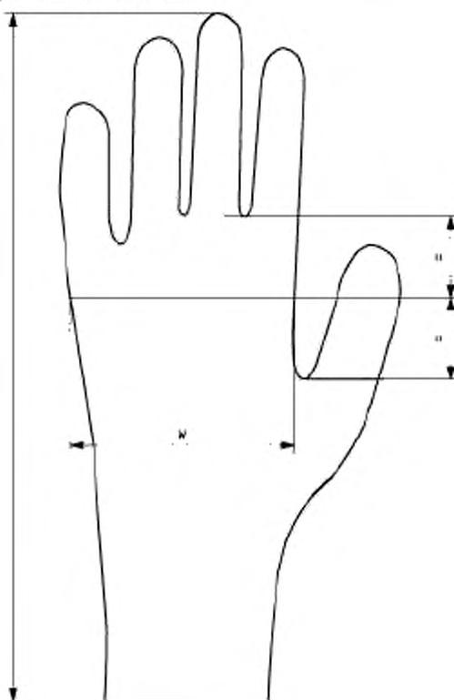
Рисунок 1 – Точки измерения ширины и длины перчатки
