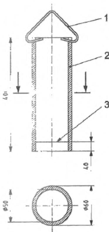
1 – крючок; 2 – стержень; 3 – линия отсчета на внутренней поверхности стенки
