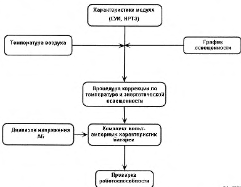
Рисунок С.1 – Блок-схема для определения устанавливаемых значений источника постоянного тока, имитирующего фотоэлектрическую батарею системы
