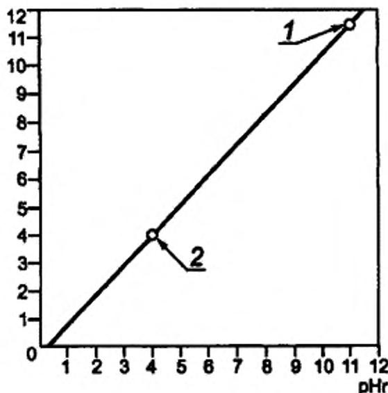
1 — показание прибора в щелочном безводном буферном растворе  $\text{pH} 11,5$ ; 2 — значение прибора, отрегулированное в безводном кислотном буферном растворе  $\text{pH} 4,0$ .
