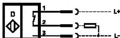
Рисунок F.1 — Примеры символов бесконтактных датчиков
