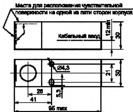
Рисунок А.1.3 (IC) — Габаритные размеры
