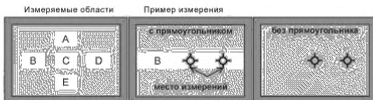
Рисунок 70 — Измерение затенения — испытательное изображение с примером процедуры
