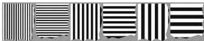
Рисунок 17 — Примеры испытательного изображения горизонтальных и вертикальных полос
