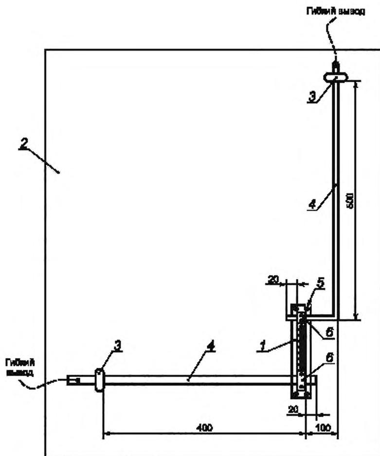
1 — шина уравнивания потенциалов; 2 — основание из изолирующего материала; 3 — устройство жесткого крепления.
