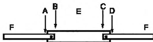
A-B, C-D — точки измерения сопротивления контактных соединений; E — сплошной проводник или многопроволочный витой проводник, соответствующий МЭК 62561-2.
