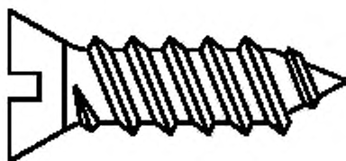
Рисунок 6 — Самонарезающий формующий винт
