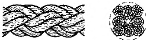
Рисунок 3- Конфигурация 8-рядного плетеного каната (тип L)
