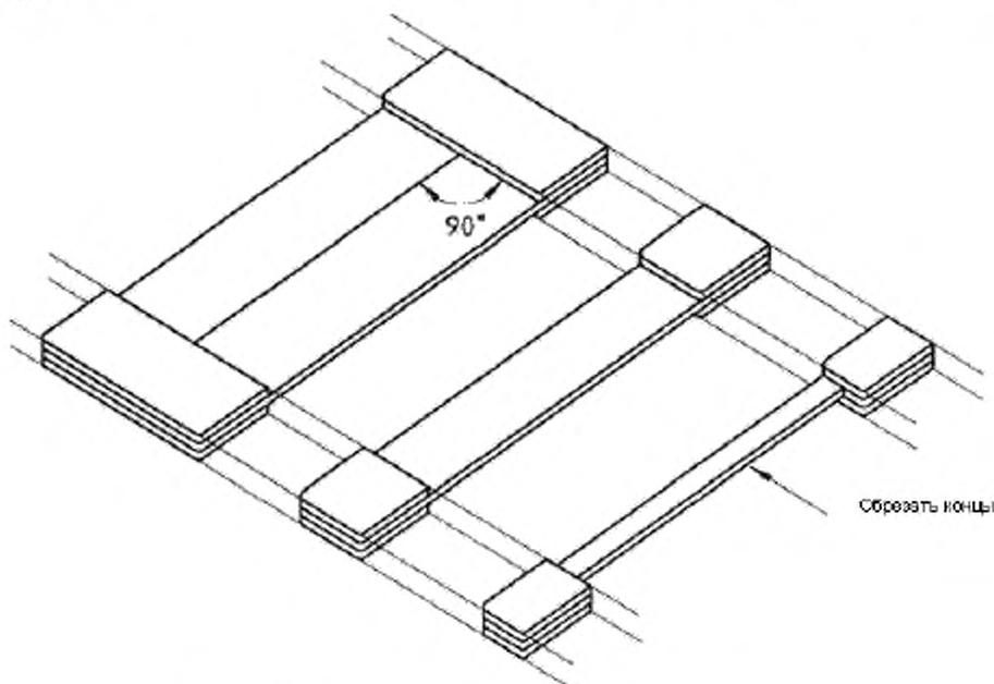
Рисунок А.1 – Прямоугольная панель для подготовки образцов
