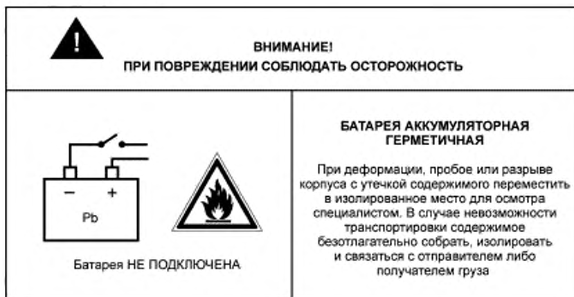
Рисунок О.1 — Предупреждающая табличка для изделий с неподключенными батареями
