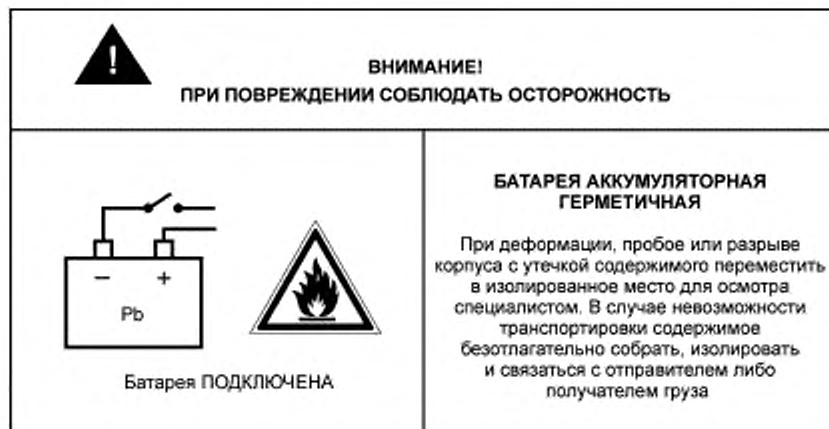
Рисунок О.2 — Предупреждающая табличка для изделий с подключенными батареями
