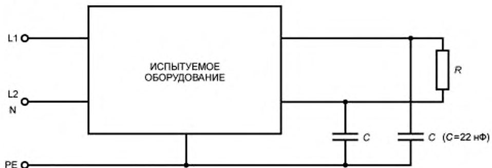
Рисунок 1.1 — Цепь для испытания изменения опорного потенциала, вызванного нагрузкой, — однофазный выход
