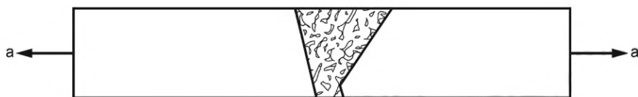
Рисунок 3 — Пластина, нагруженная осевой нагрузкой
