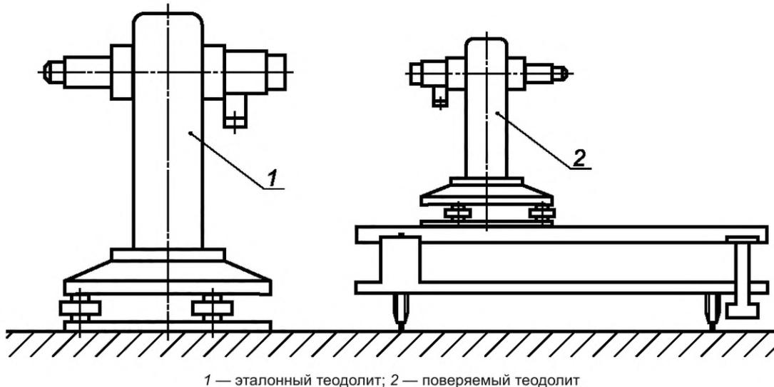
Рисунок 1 — Схема установки эталонного и проверяемого теодолитов
