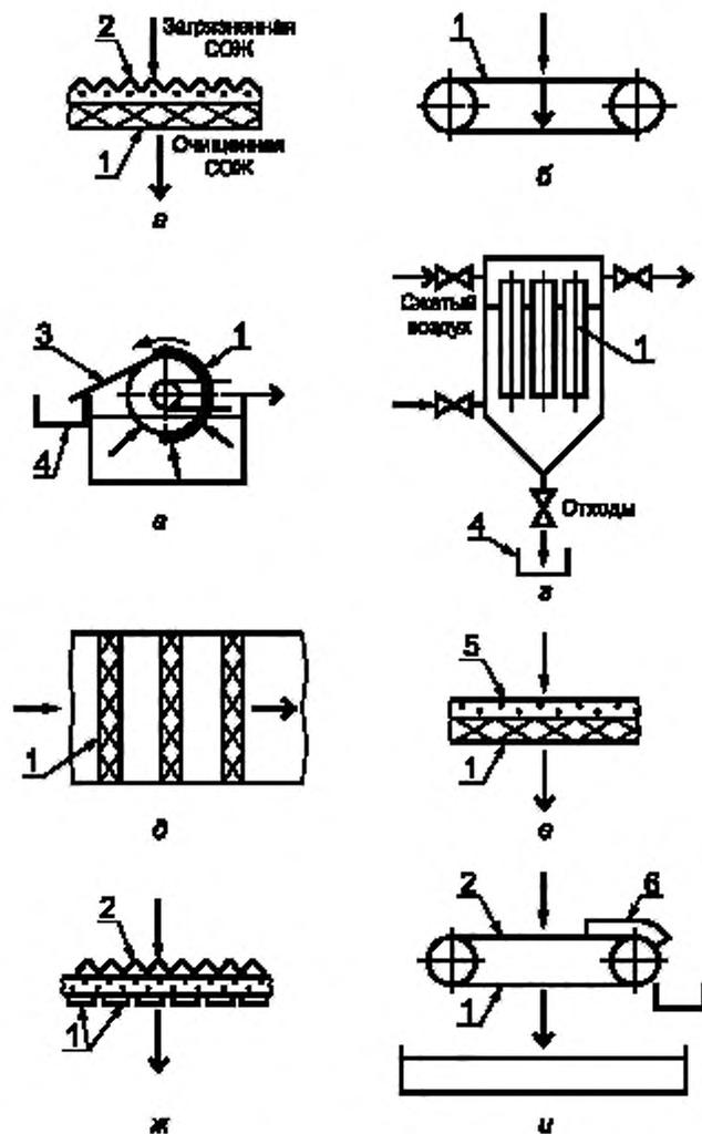
а — через фильтровальную перегородку; б — в ленточных фильтрах; в — в барабанных фильтрах; г — в патронных фильтрах; д — в кассетных фильтрах; е — в намывных фильтрах; ж — в щелевых фильтрах; и — в ленточных фильтрах
