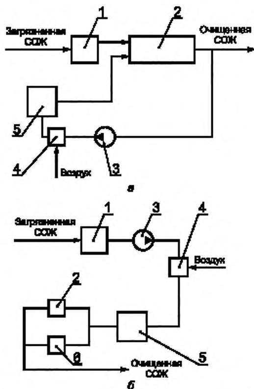
а — флотация с рециркуляцией; б — флотация с неполнолотовой подачей
