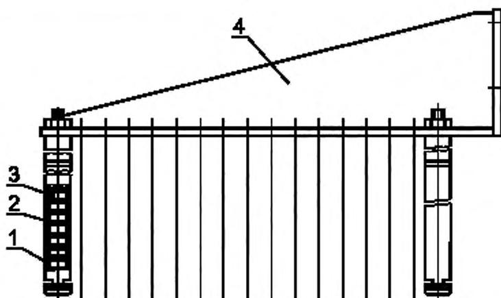
1 — латунная гильза; 2 — магнитопроводящие шайбы; 3 — магнитный элемент; 4 — траверса
