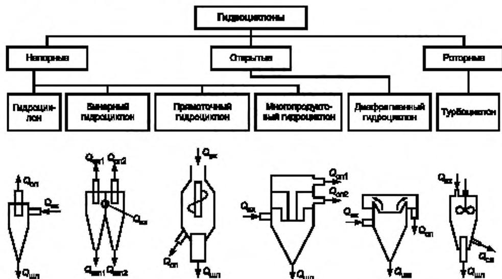
Рисунок 8 — Классификация гидроциклонов
