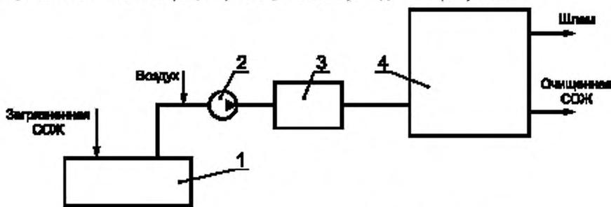
1 — емкость; 2 — насос; 3 — напорный бак; 4 — флотатор
