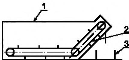
1 — резервуар, 2 — скребковый конвейер, 3 — тара для шлама
