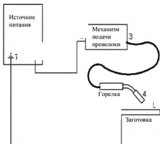
Рисунок В.1 — Пример оборудования MIG/MAG
