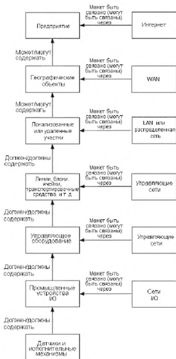
Рисунок 14 — Пример модели объектов непрерывного производства
