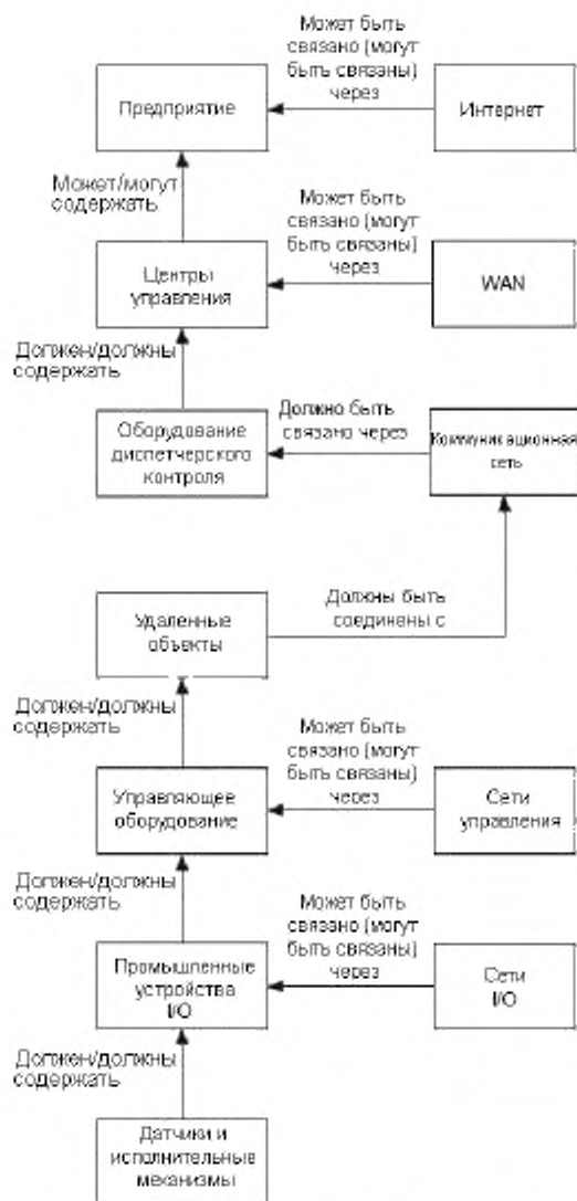
Рисунок 15 — Пример модели объектов системы SCADA
