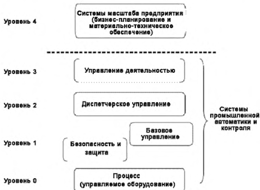
Рисунок 12 — Базовая модель по МЭК 62443
