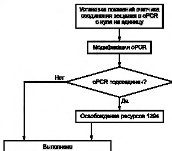
Рисунок 21 — Прерывание соединения выхода из вещания
