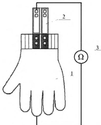
1 — защитная перчатка; 2 — контактный вывод; 3 — омметр
