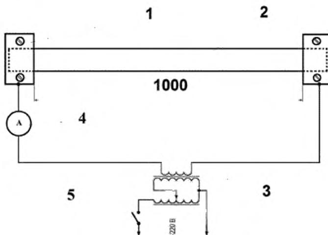
1 — разъемные двойные медные пластины; 2 — испытуемый образец; 3 — регулируемый источник напряжения, 4 — амперметр; 5 — выключатель
