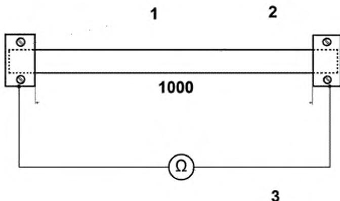
1 — разборные сдвоенные медные пластины; 2 — испытуемый образец; 3 — омметр
