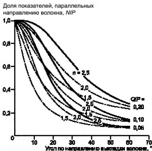
Рисунок Д.10 — Влияние угла зерна на механические свойства чистой древесины согласно формуле Хэнкинсона
