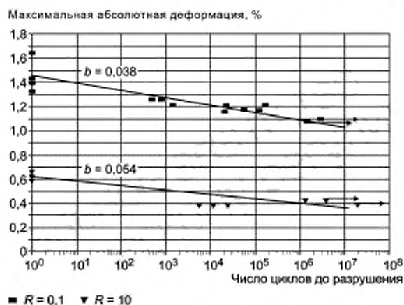
Рисунок Д.4 — Характерные усталостные кривые S - N для композиционного материала на основе углерода/винилэфира
