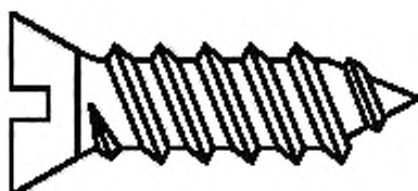
Рисунок 1 — Самонарезающий формующий винт (см. 3.6.10)
