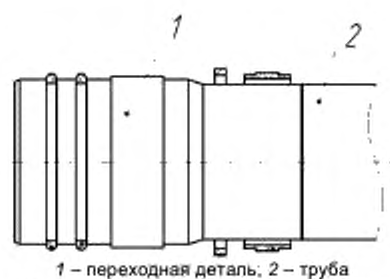
Рисунок А.4 – Переходная стальная деталь со сварным соединением
