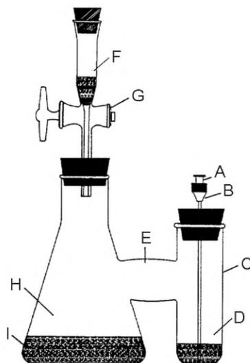
А — пробка из силиконовой резины; В — игла; С — пробирка; D — конец иглы, на которую надета силиконовая трубка; Е — соединяющий элемент между колбой Эрленмейера (H) и пробиркой (C); F — фильтр с аскаритом; G — пробка с краном; H — колба Эрленмейера; I — проба почвы
