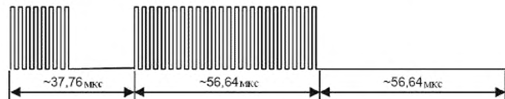
Рисунок 16 – Конец кадра при использовании одной поднесущей
