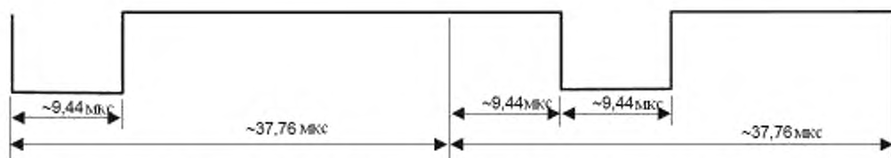
Рисунок 8 – Начало кадра при способе кодирования «1 из 4»
