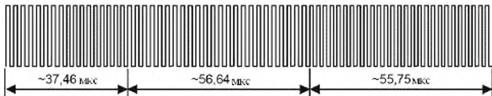
Рисунок 17 – Конец кадра при использовании двух поднесущих
