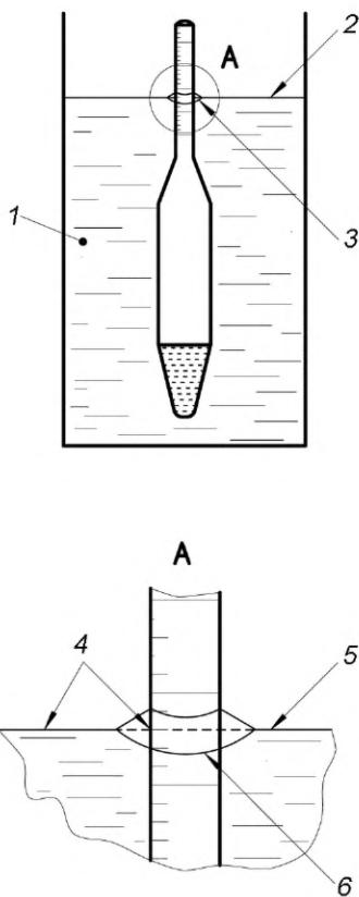
1 — жидкость; 2 — горизонтальная плоская поверхность жидкости; 3 — нижняя часть мениска; 4 — точка считываения шкалы; 5 — горизонтальная плоская поверхность жидкости; 6 — мениск
