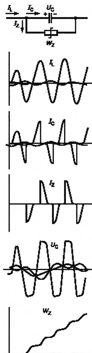
Рисунок 4 — Осциллограммы энергии, напряжения и тока при коротком замыкании на землю одной фазы
