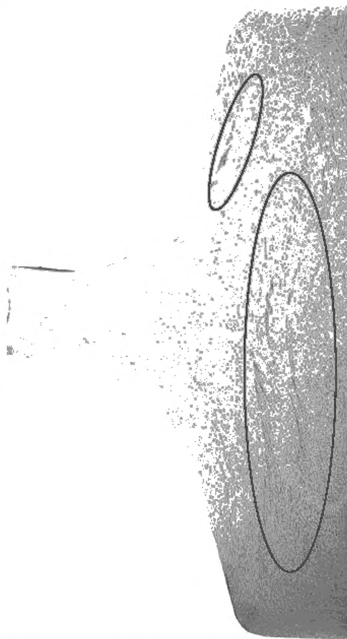
Рисунок Б.22 – Эталон № 22 (ликвационные полосы, не выходящие на поверхность ступицы или в зону перехода от диска к ступице)
