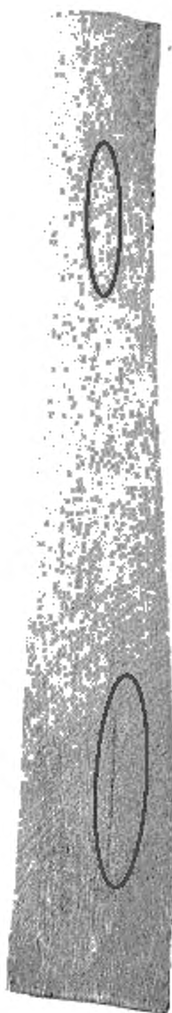
Рисунок Б.19 – Эталон № 19 (ликвационные полосы)
